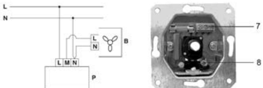
För att normal drift ska fungera på avsett sätt är det nödvändigt att varvtalsregulatorn regleras för minimal rotationshastighet:
