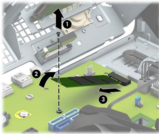
10. M.2 SSD 카드를 설치하려면, 카드를 약 30° 각도로 잡은 상태에서 카드의 핀을 시스템 보드 커넥터에 밀어 넣습니다(1). 카드의 다른 쪽 끝을 아래로 누른 다음(2), 카드를 나사로 고정합니다(3).
