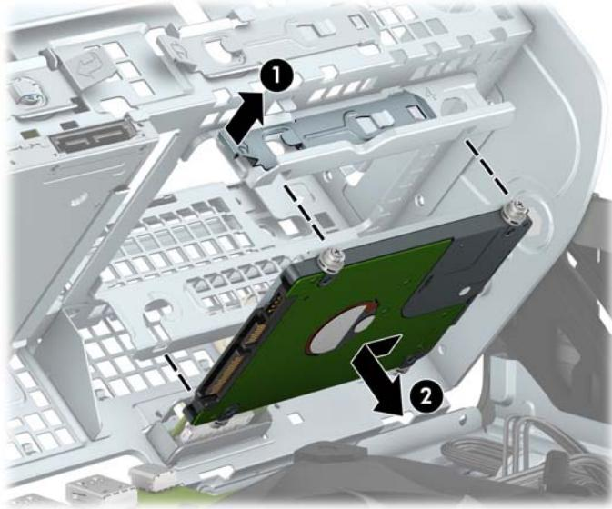
11. 새 드라이브를 설치할 경우 [34페이지의 6.35cm 하드 드라이브 설치](#)을 참조하십시오. 새 드라이브를 설치하지 않는 경우에는 드라이브 케이지를 아래로 돌려 전면 베젤과 액세스 패널을 다시 장착합니다.
