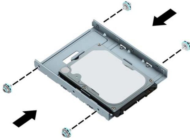
8. 하드 드라이브의 앞면에 있는 장착 나사를 드라이브 케이지에 있는 슬롯에 맞추고 드라이브의 앞면을 아래로 누른 다음 앞으로 밀어 베이에 끼웁니다(1). 그리고 나서 드라이브의 뒷쪽을 눌러 드라이브 베이에 끼워서(2) 제자리에 고정시킵니다.
