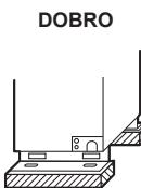
4. Gumu otpornu na vibracije (uključujući na vibracije otporne blokove) montirajte tako da pristaje ispod cijele učvrsne noge.
